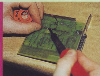
6: Printen renses for tinn der hvor beina har sittet. Her bruker jeg en loddelisse, men en tinnpumpe er egentlig det beste.
